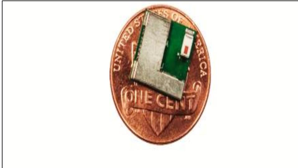
**Fig. 2.11. Chip antenna [62]**
